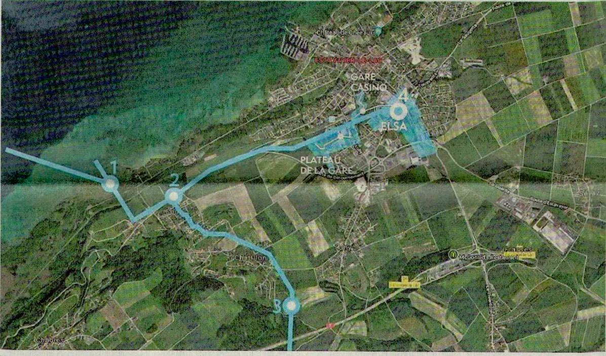
L'eau sera prise à quelque 50 mètres de profondeur pour être amenée à une station de pompage (1), elle sera ensuite acheminée à une station de traitement équipée d'un échangeur thermique (2). Seront également construits un réservoir de mise sous pression (3) et une sous-station de distribution (4). **PLAN GROUPE E**
